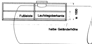
Arbeitsbühne mit freistehendem Geländer z.B. bei Chemikalien
